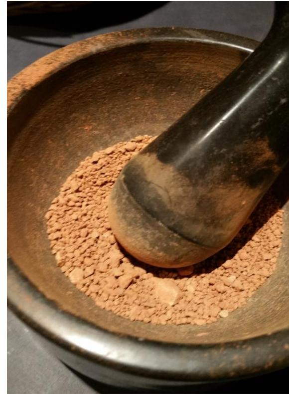
Die Erde wurde in einem sehr massiven Steinmörser gemörsert und mehrmals gesiebt. Somit entstehen verschiedene Siebgrößen, Feinheit der Erde, fast wie Staub, oder Tonmehl. (Stein)
