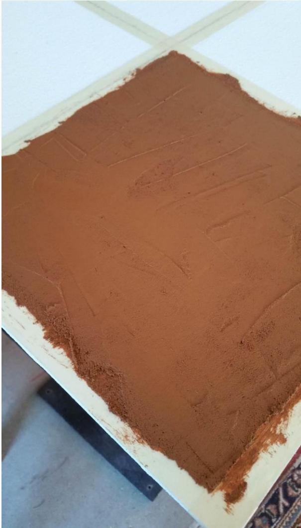
Herstellen einer Musterplatte – Gipskartonplatte (600 x 600 mm) mit einer Kreide-Wasserglas-Grundierung mit feiner Körnung vorbehandelt.
