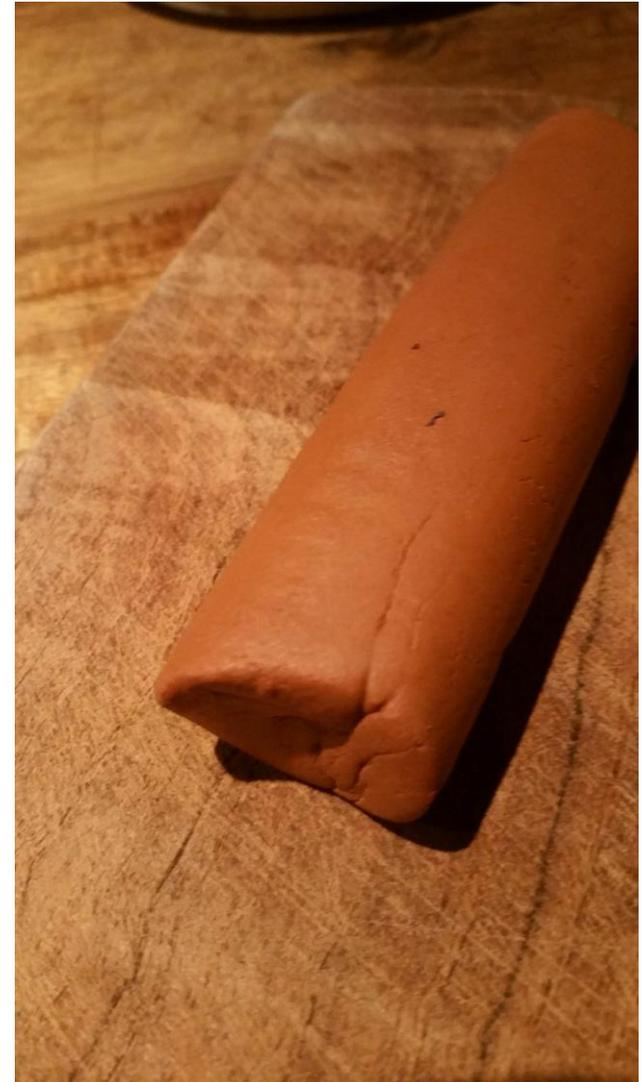
Nach dem Einmauken (Zeit und Ruhe) in Wasser und kreisendem Anrühren (Mischungsverhältnis!) wird die Tonmasse mit der Hand durchgeknetet und in eine Form gebracht, sowie die Konsistenz bewertet. Verschiedene mechanische Prüfverfahren helfen bei der Bestimmung des Tongehaltes ...
