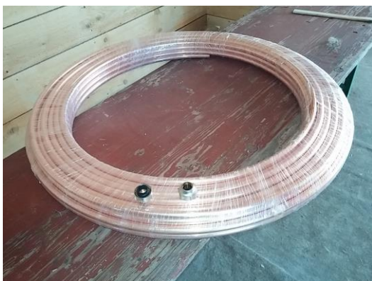
Abbildung 1 – Die vom Heizungsbauer Roland Auerbacher gelieferte Kupferrohr-Rolle (mittel-hart, 15 mm)
