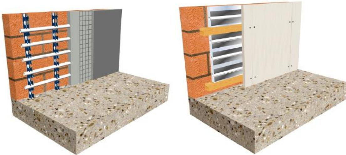
*Abbildung 4 - Die vielfältigen Bauweisen von Wandheizungs- und Kühlflächen erlauben gerade in der Modernisierung umfassende Anwendungsoptionen. Quelle: BDH*
