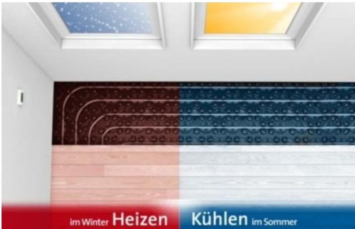
Abbildung 3 - Fußbodenheizung/-kühlung in einem System - Quelle: BDH
